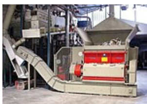
drticí stroj drtí sbíraný papír
